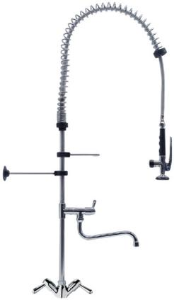
*Douchette EC/EF monotrou hauteur standard 1200 mm, mélangeur ¼ de tour, embout de douchette renforcé et flexible avec double protection, à poser sur plonge avec col de cygne, fabrication italienne*
