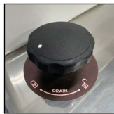
3. ROBINET DE VIDANGE DE LA CHAMBRE DE STÉRILISATION À 2 POSITIONS : - OUVERT - FERMÉ
